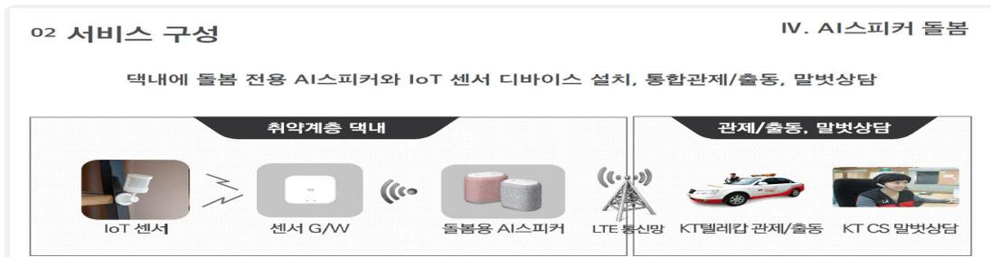
AI스피커 돌봄 서비스는 택내에는 돌봄용 AI스피커, 센서 게이트웨이, IoT 센서가 설치되고, 원격에는 통합관제시스템을 통해 응급상황 시 KT 텔레캅이 직접 현장에 출동하여 긴급상황을 대응해 주며, 부정적인 단어를 많이 사용하는 취약계층에게는 KT CS 전문 상담원이 직접 말벗 상담 서비스를 제공하는 것으로 구성되어 있다.
